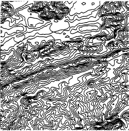
图 3 经过 2 次小波分解得到的等高线图 Fig. 3 Contours after twice Wavelet transforms
